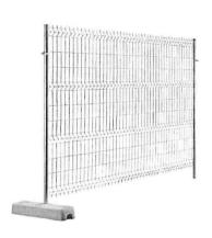
in lamiera, con irrigidimenti nervati e paletti di sostegno composti da tubolari metallici zincati, di diametro non inferiore a mm 40 controventati, con base realizzata in blocchi di calcestruzzo dal peso non inferiore a 35 kg, completi di morsetti di collegamento, elementi cernierati per l'inserimento di un modulo porta (adeguato per l'acceso carrabile) ed eventuali terminali, il tutto già compreso e compensato con la voce del seguente articolo; i moduli dovranno avere altezza non inferiore a
