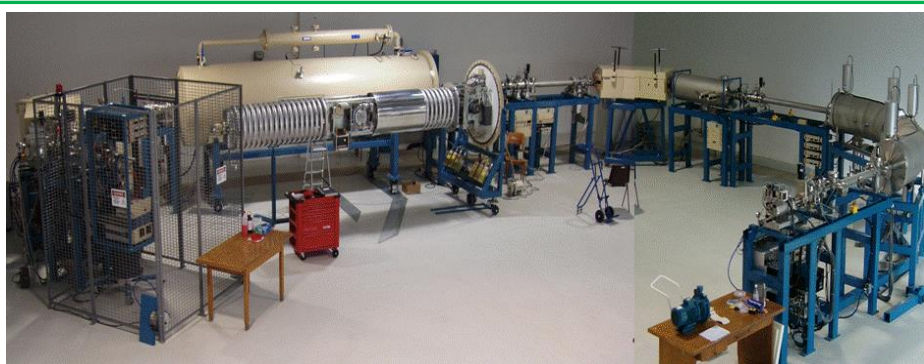
Figura 3. Il sistema AMS, basato su un acceleratore elettrostatico Tandem Pelletron da 3 \times 10^6 V in uso presso il Laboratorio CIRCE dell'Università degli Studi della Campania "Luigi Vanvitelli".
