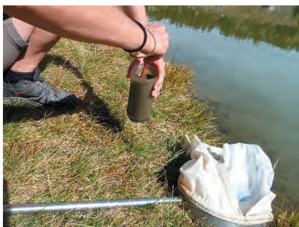
Fig. 3 - Metodi di campionamento per sedimenti duri e litorali dei laghi con retino immanicato.
