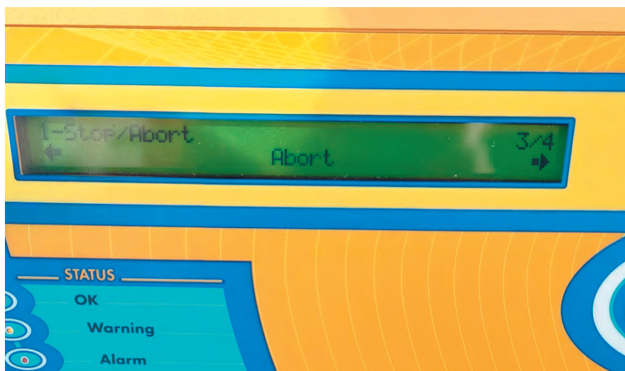
Figura 13 - Selezione del sotto menu di terminazione del ciclo di campionamento.
