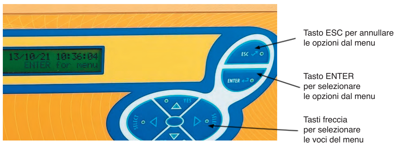
Figura 4 - Particolare della tastiera presente sullo strumento FAI Hydra.
