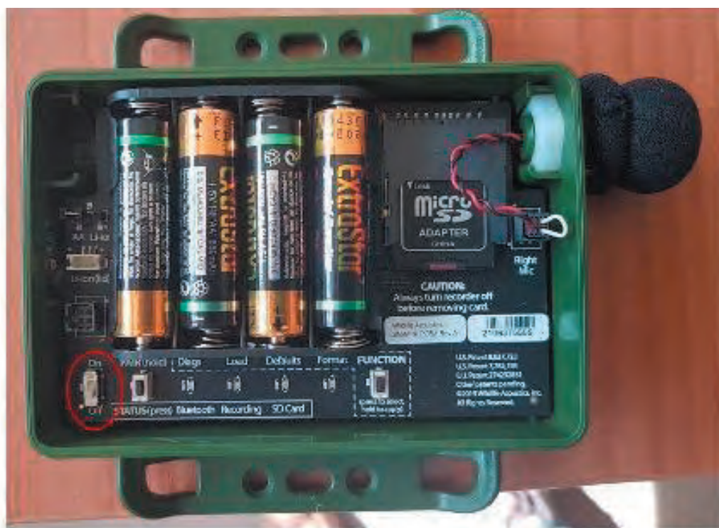
Figura 2 - Dopo aver rimosso il coperchio è visibile l’interruttore per accensione (cerchio rosso).
