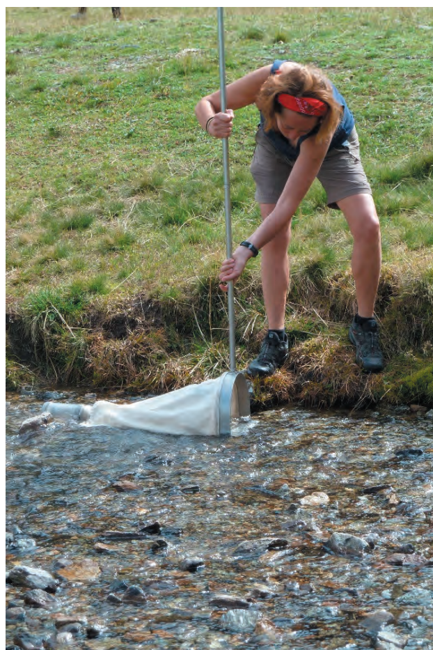
Fig. 3 - Metodi di campionamento per sedimenti duri e litorali dei laghi con retino immanicato.
