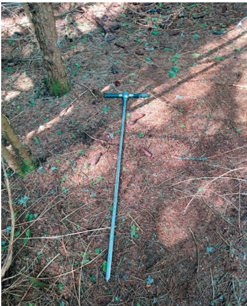
Figura 1 - Trivella utilizzata per favorire l'inserimento dei lisimetri.
