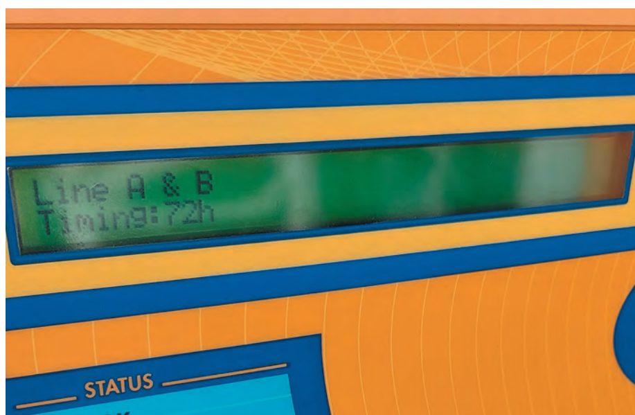
Figura 5 - Selezione della durata del ciclo di campionamento mediante le frecce del tastierino dello strumento FAI Hydra.
