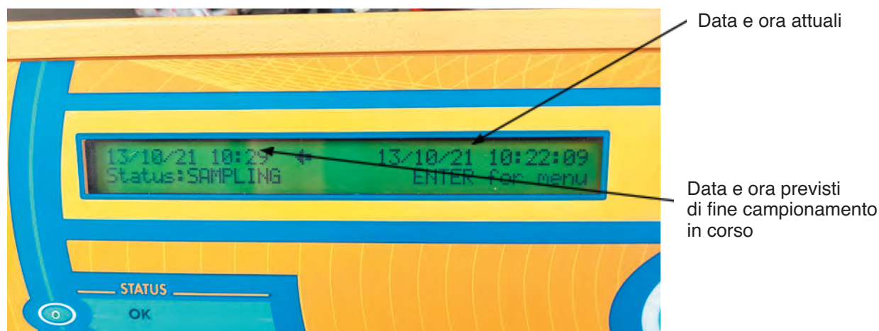
Figura 11 - Esempio di indicazione dello stato di campionamento sullo schermo del campionatore FAI Hydra.
