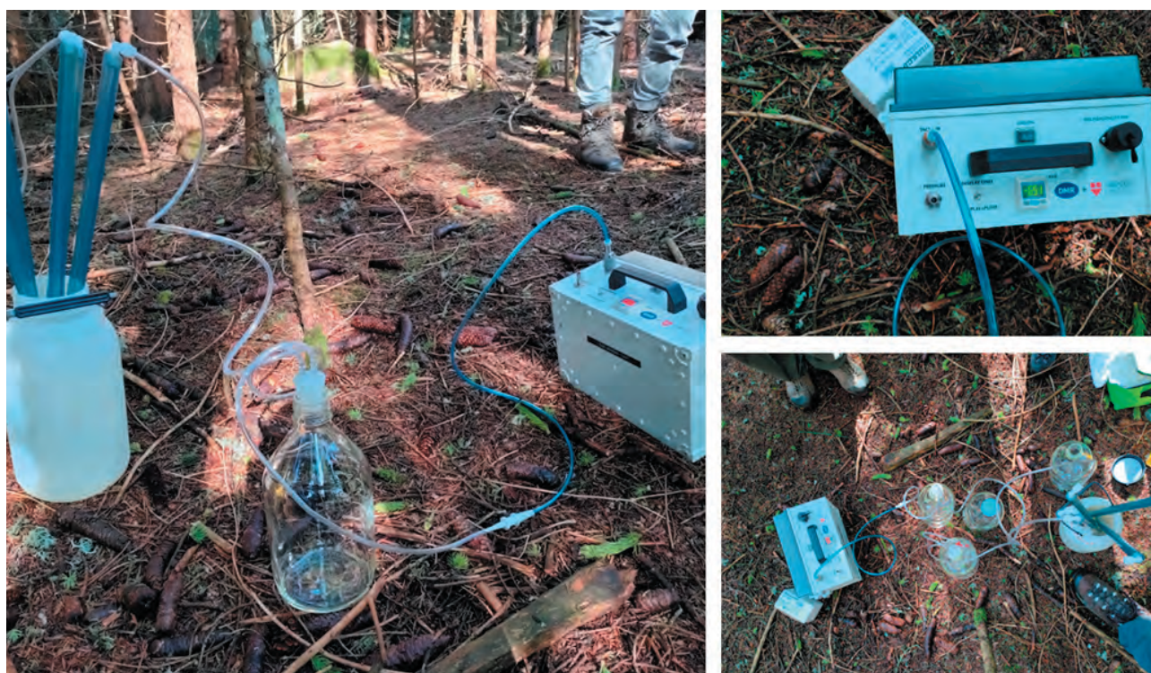
Figura 2 - Preparazione dei campionatori a tensione.
