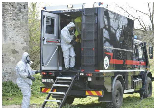
Le Laboratoire Mobile permet d'effectuer des analyses terre air et de transmettre en temps réel les données collectées.
