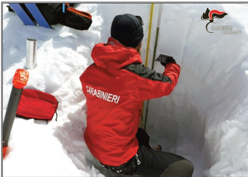
Fig. 2. Un Esperto Meteomont analizza i cristalli di neve nei vari strati del manto nevoso in occasione di un rilievo itinerante
