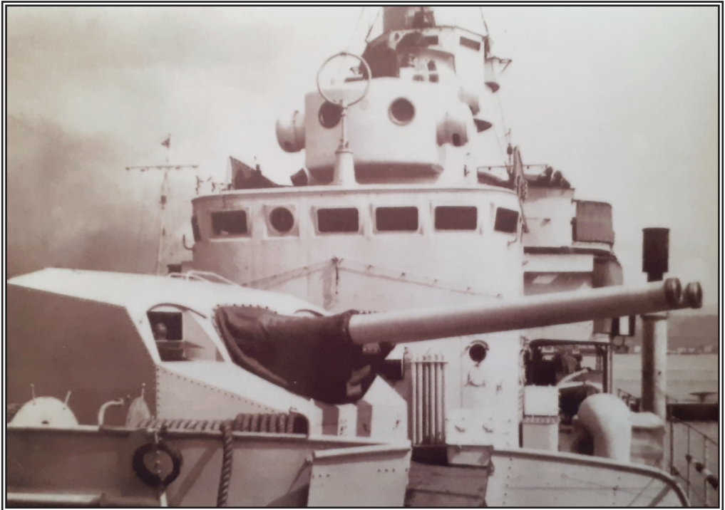
Una vista della zona prodiera del Carabiniere nella quale si notano il paraonde, il complesso binato scudato da 120 millimetri, la plancia e sopra di essa la torretta della direzione del tiro dotata dell'A.P.G. (apparecchio di punteria generale) e del telemetro
