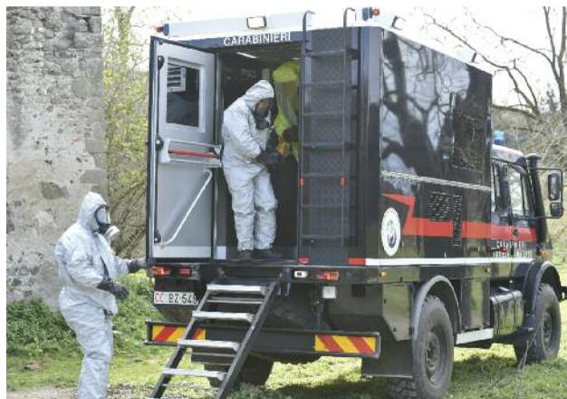
Il Laboratorio Mobile consente di effettuare analisi terra-aria e di trasmettere in tempo reale i dati raccolti.
